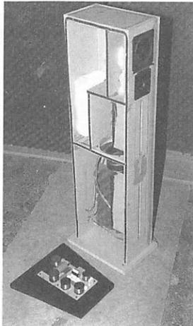
Butterworth-Filter zu realisieren. Genau so etwas hatten wir ja gesucht! Wenn unser Mitteltöner im eingebauten Zustand eine Resonanzfrequenz von 85 Hz hat ergibt sich der Filterübernahmepunkt genau bei 150 Hz. Aus den Berechnungen erhält man ebenso die Frequenzweichenbauteile, die Einbaugüte und das Volumen der Mitteltonkammer. Für unsere
