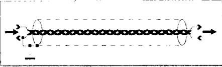
Abb. 7: Parallelsymmetrisches Kabel (Link-Leitung) für unsymmetrischen Betrieb (Cinch). Elektrische Schirmung nur einseitig aufgelegt.
