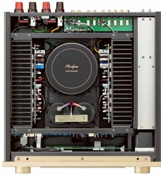
**Auch der E-800 offenbart die für Accuphase typische Topologie mit zentralem Netzteil und Leistungselektronik an den Seiten. Der Metallschacht rechts schirmt die Module ab.**
