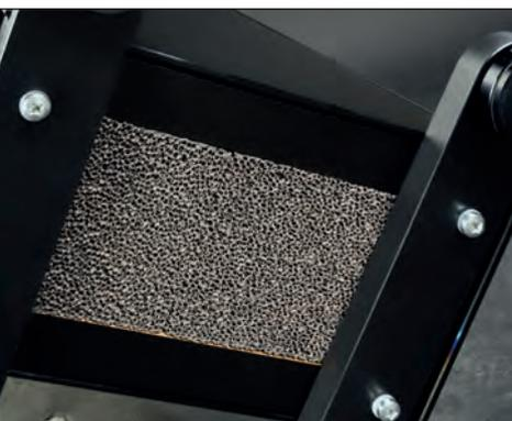
Durch den schalldurchlässigen Boden strahlt der Tieftöner in Richtung Boden ab
